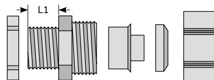
零件 代号: 螺帽 MGL 本体 MGB 夹紧爪 MGC 夹紧圈 MGS 迫紧头 MGN
