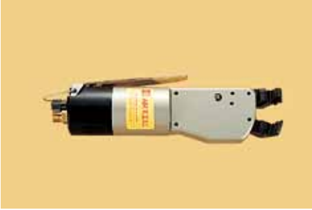
型号：BN-19（气动式） 总长：165mm 重量：500g 气体压力：5 ~ 6kg/cm 2 气体消耗：160cm 3 /stroke
